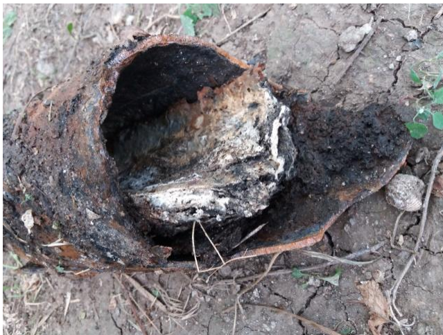
Состояние труб до замены (все стоки возвращались в подвал вместе с грунтом через трещины в трубах, подмывая фундамент)
