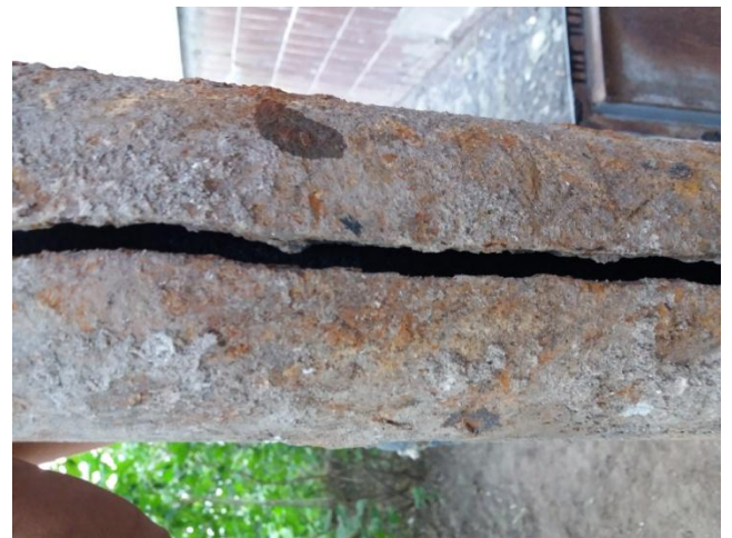
Состояние труб до замены (все стоки возвращались в подвал вместе с грунтом через трещины в трубах, подмывая фундамент)
